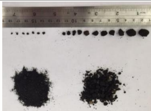
Gambar 1. Buton Granular Asphalt BGA (Ukuran dalam mm)
