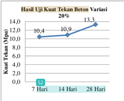
Sumber: Hasil Pengujian 2021 Gambar 4.10 Hasil Uji Kuat Tekan Beton Variasi 20% Umur 7,14 dan 28 Hari
