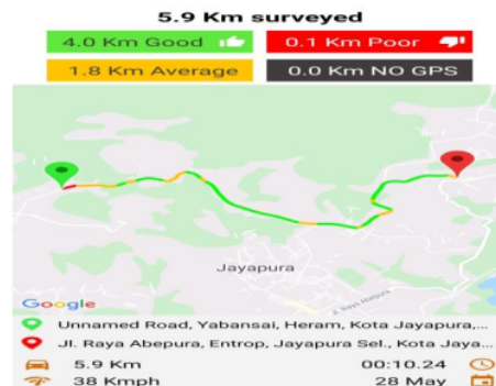
Gambar 9. Pengukuran IRI dari arah Waena kearah Entrop (Hasil Aplikasi Roadbounce)
