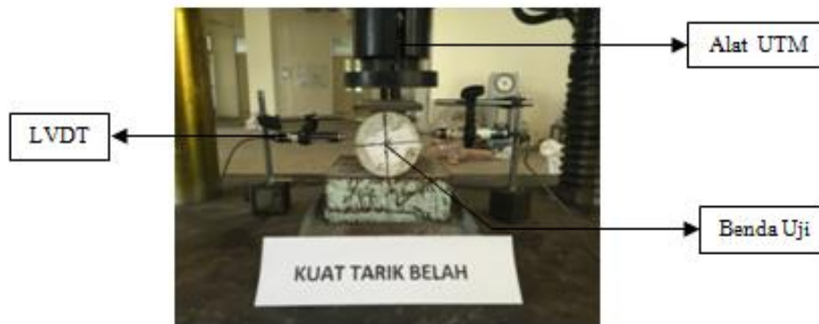
Gambar 5. Posisi benda uji pada pengujian kuat tarik belah beton
