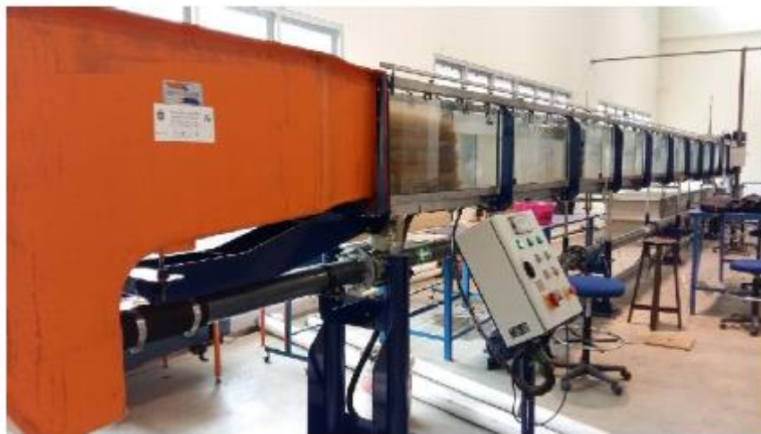
Gambar 2. Saluran pembangkit gelombang (Wave Flume)
