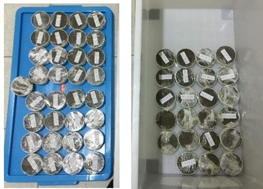
Gambar 6. Perawatan benda uji setelah dicampur bakteri
