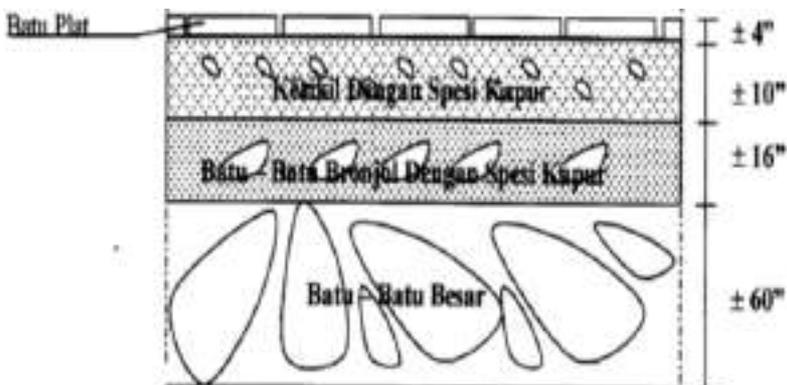
**Gambar 1.1:** Kontruksi perkerasan romawi, (Hartanti Atmadjaja, 2018)
