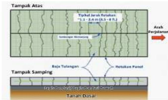
**Gambar 2.9:** Skema perkerasan kaku menerus dengan tulangan
