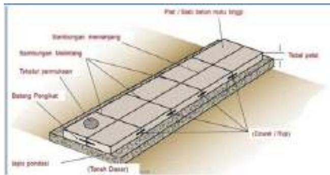
**Gambar 2.5:** Tipe dan lokasi sambungan pada perkerasan kaku
