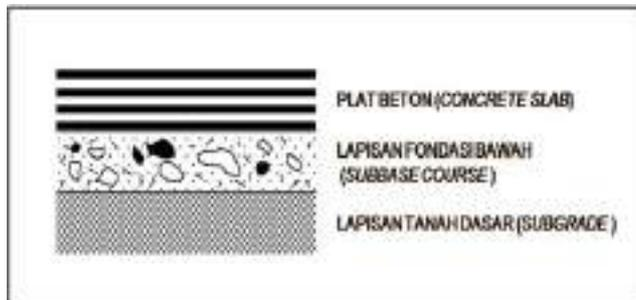
**Gamabar 1.4:** Lapisan Konstruksi perkerasan kaku (Rigit Pavem)ent
