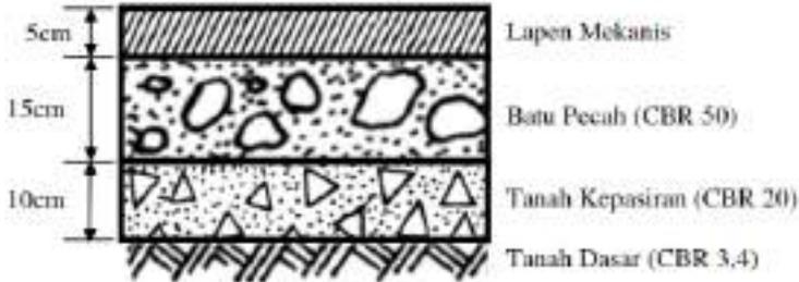
**Gambar 11.4:** Susunan Perkerasan Untuk Umur Rencana 10 Tahun
