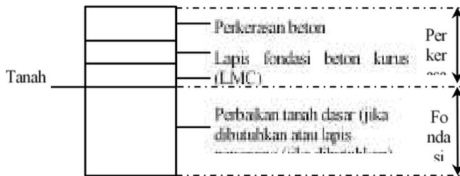
**Gambar 10.4:** Struktur perkerasan kaku tanah asli (Bina Marga, 2017)
