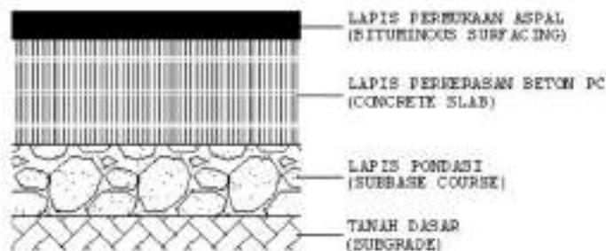
**Gambar 1.5:** Konstruksi Perkerasan Komposit (Perkerasan Komposit)
