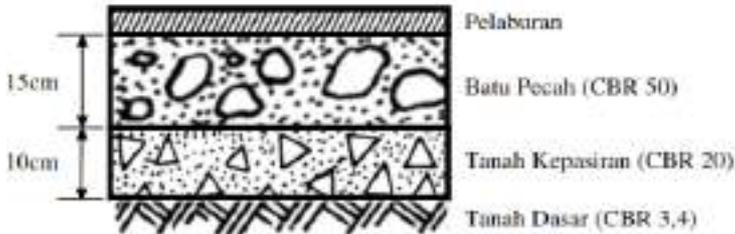
**Gambar 11.3:** Susunan Perkerasan Untuk Umur Rencana 5 Tahun
