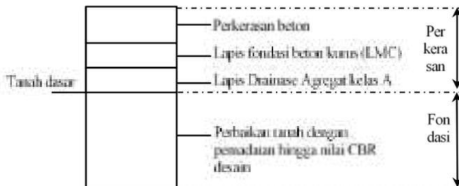
**Gambar 10.5:** Struktur perkerasan kaku dengan timbunan (Bina Marga, 2017)
