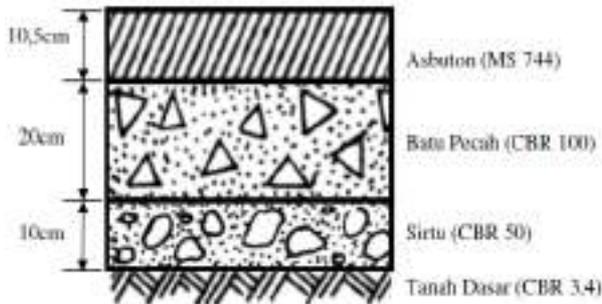
**Gambar 11.5:** Susunan Perkerasan Untuk Umur Rencana 10 Tahun Pada Lalu Lintas Tinggi
