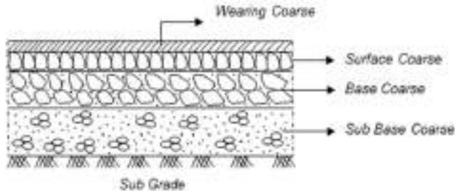
**Gambar 4.1:** Struktur perkerasan lentur (Ali N. dkk., 2010)
